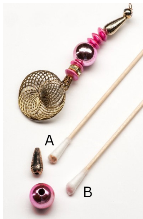
En inkonklusiv DMG test (A brun) og en positiv DMG test (B lyserød) af to komponenter i samme smykke.
